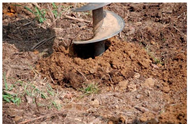
Abbildung 68: Bohrspindel mit 30 cm Durchmesser
